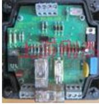
主板电路与控制电路采用光耦隔离，低电压控制系统。是目前全球磁座钻机最先进的电路设计。最大的特点是线路耐用，不易损坏。
