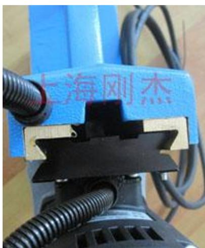
坚硬耐磨的双导轨设计，可调节的电机滑动传动，具有更大的行程空间，钻孔深度可达 100mm（不上顶针的情况下可达 300mm）
