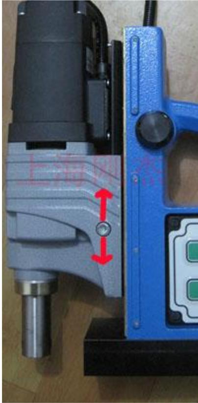
螺丝钉完全的埋入，以保证操作人员的安全，用于调节和固定导轨间隙。（可以上下调节电机，以达到更大的行程，方便在不同的环境中使用。
